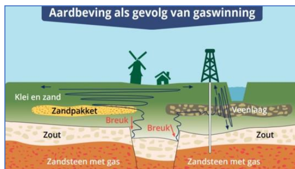
Figuur 20. Afbeelding van de Groningen Bodem Beweging (GBB). Er is geen enkele aanwijzing in de NAM data dat de zoutsteenlaag scheuren zou vertonen. Ook hier zijn de verhoudingen van de laagdikten disproportioneel (voor de duidelijkheid?).
