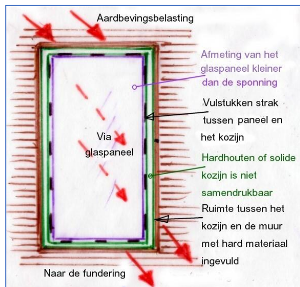
Figuren 80. Gelamineerd, isolatieglas kan zeer hoge drukspanningen en ook schuifspanningen in het vlak van het glaspaneel opnemen.
