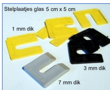
Figuren 81. Links: Gewone plastic stelplaatjes voor glas kunnen gebruikt worden als de kier wordt opgevuld met verhardende epoxy zodat de hele paneel draagt.
