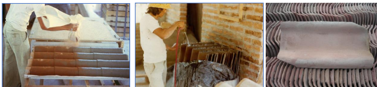
Figuren 54. Het begon in Honduras met half-grote dakplaat productie, maar dat ontwikkelde later naar een kleiner, handzamer en sterker model van 1 ft x 1,5 ft. J.P.M. Parry en Associates verkochten honderden minifabriekjes in vele ontwikkelingslanden voor bewoners zelfproductie van deze dakpannen.
