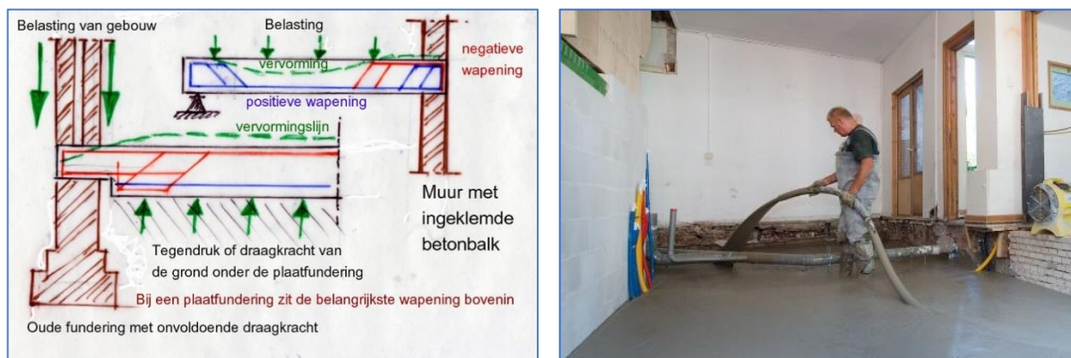
Figuren 1-85. Bij plaatfundering zit de betonwapening bovenin.
