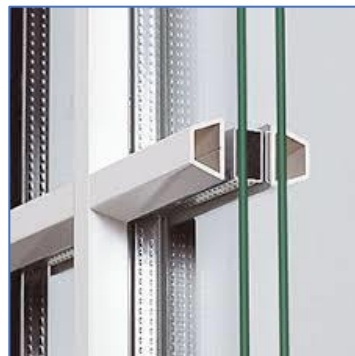
Midden: Wiener sprossen. Hier loopt het glas door, wat veel gunstiger is voor de gemiddelde isolatiewaarde van de hele ruit dan bij onderbreking van een spacer.
