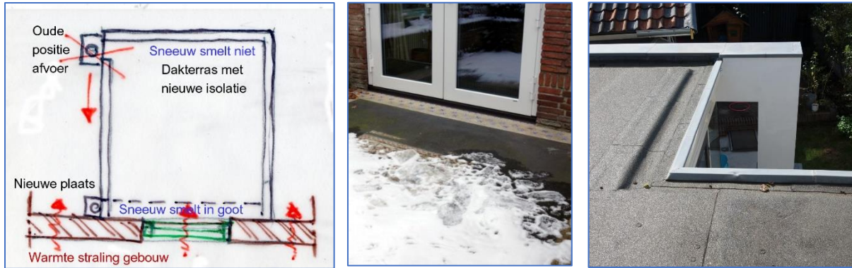
Figuren 7. Bij een smeltwater afvoergoot moet het gesmolten water direct langs de muur worden afgevoerd zonder dat er een verstopping van de smeltwater afvoer kan plaats vinden. De midden afbeelding toont het effect van de warmtestraling, terwijl de nieuwe kunststof deur wel triple glas heeft. Rechts is het dak beperkt en waterdicht na-geïsoleerd, waarbij de gootrand op de oorspronkelijke hoogte is gehouden.
