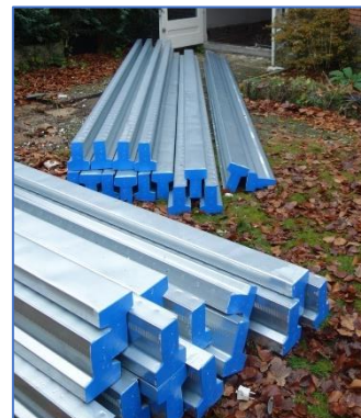
Figuren 32. Links : I betonbalkjes. Midden : dunmetalene I-profielen. Rechts : Dunmetalene I kokerprofielen die op maat geleverd of gezaagd worden.
