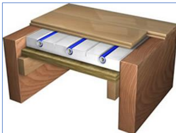
Figuren 11. Links.: Bij LTV-vloerverwarming op de balken en planken is er voldoende hoogte tussen de balken voor isolatie. Het hoogteverlies in de kamer is 3 cm voor de LTV en 1 cm voor laminaat. Dit is de eenvoudigste oplossing en het minste werk. Rechtsboven: Bij LTV-vloerverwarming tussen de balken is er geen hoogteverlies in de kamer, maar het is heel veel meer werk . Oude vloerdelen kunnen worden gezaagd om de ondersteuning te maken. Rechts: Hier is de isolatie onder de LTV nog niet aangebracht.
