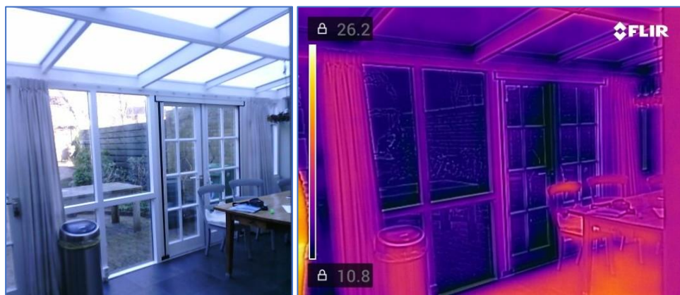
Figuren 2. IR-combi foto van serre aanbouw met vloerverwarming. Terwijl de vloer warm is (oranje) verliezen de zij- en dakramen heel veel warmte (paars).
