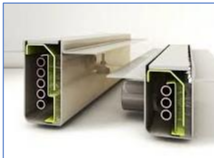
Figuren 6. Verschillende constructies van de goot met de wateraansluitingen. Hoe minder de metalen bak van de goot de warmte van het douchewater opneemt hoe economischer het systeem werkt.
