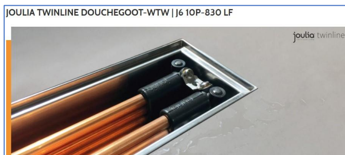
Figuren 7. Verschillende merken hebben elk hun eigen inbouwhoogtes. Links. Het Zwitserse merk Joulia heeft een efficiëntie van 55% bij een waterverbruik van 9 liter per minuut. Tevens heeft het een lage inbouwhoogte van slechts 12 cm. Bij de aanschaf moet ook gekeken worden naar de mogelijkheid om het systeem eenvoudig schoon te kunnen maken. 11
