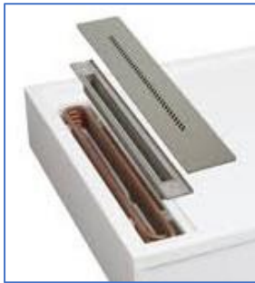
Figuren 6. Verschillende constructies van de goot met de wateraansluitingen. Hoe minder de metalen bak van de goot de warmte van het douchewater opneemt hoe economischer het systeem werkt.
