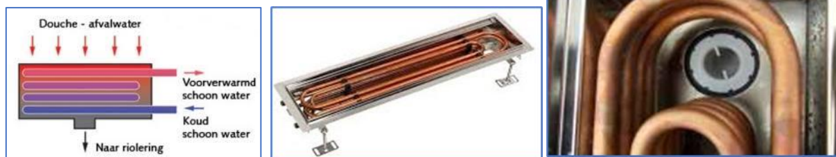
Figuren 5. Goot WTW voor de douche. De koud water aansluiting gaat door de goot. Hoe meer pijpen er door de goot lopen hoe efficiënter het systeem is, maar dan is de inbouwdiepte ook hoger.
