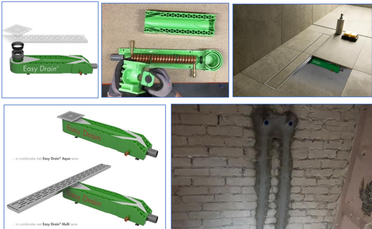
Figuren 9. Horizontale WTW Easy Drain is van kunststof en de montage kan op verschillende manieren onder de douchevloer. Dit model kan direct op een putje of platte goot worden aangesloten en in twee richtingen ingebouwd. De hoogte van de afvoer is belangrijk voor de inbouwhoogte.
