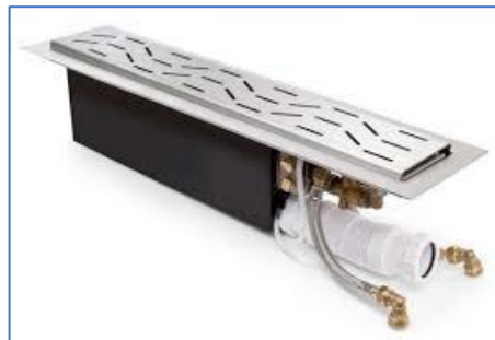
Figuren 7. Goot WTW voor de douche. De koud water aansluiting gaat door de goot. Hoe meer pijpen er door de goot lopen hoe efficiënter het systeem is, maar dan is de inbouwdiepte ook hoger.
