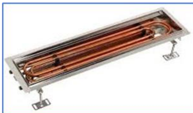
Figuren 7. Goot WTW voor de douche. De koud water aansluiting gaat door de goot. Hoe meer pijpen er door de goot lopen hoe efficiënter het systeem is, maar dan is de inbouwdiepte ook hoger.
