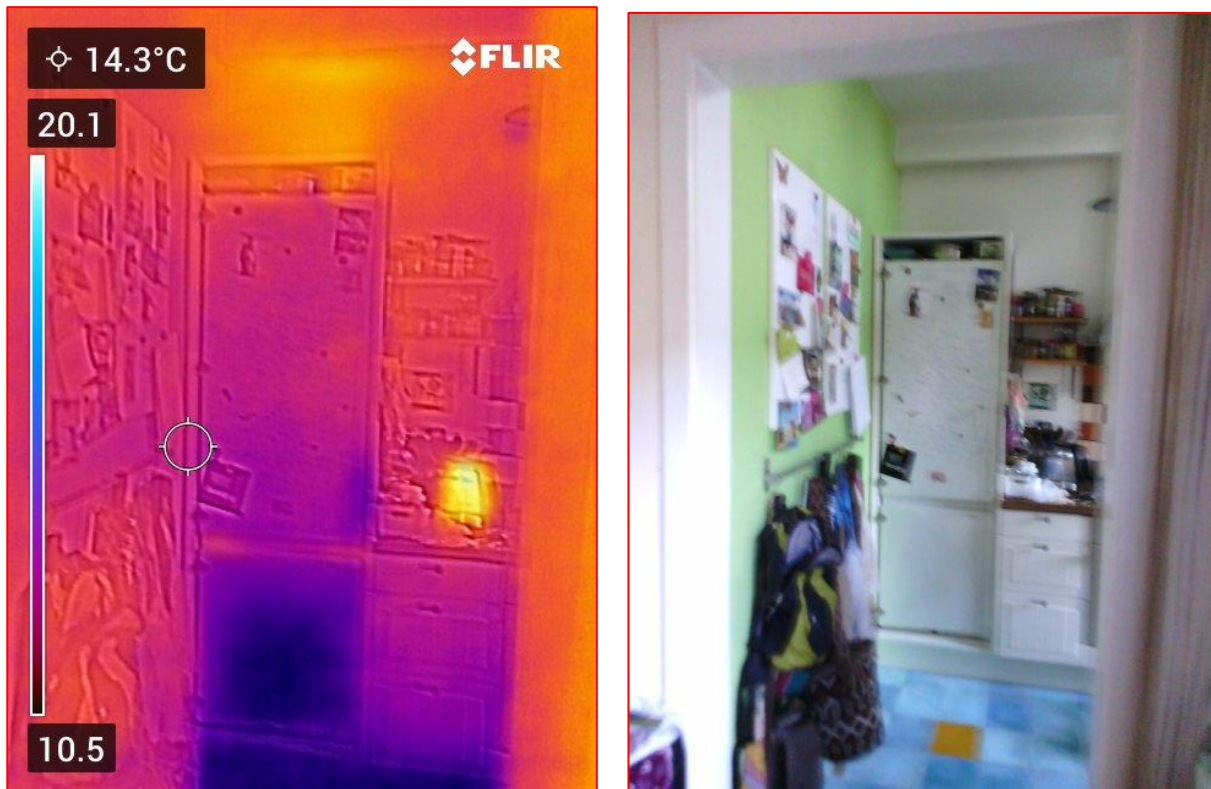
Figuren 1. Op deze Infra-Rood (IR) foto is te zien dat de oude koelkast uit twee delen bestaat, met aan de onderzijde de diepvries. De temperatuurschaal staat links langs de foto. De thermische isolatie van de diepvries (onder de koelkast) laat te wensen over ( oude koelkast). De warme lucht die boven achter de koelkast uit komt verwarmt het plafond.
