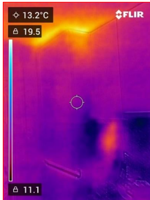
Figuren 7. Voorbeeld van een oude koelkast met slechte wandisolatie (donkerblauw rechts).
