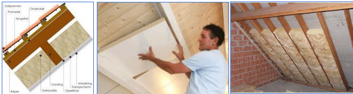
Figuren 4. Schuine dakisolatie tussen de gordingen creëert lange warmtelekken. Links: Hier is het beter om tussen de kepers, over de gordingen eveneens een laag isolatiemateriaal toe te passen waardoor er slechts op de kruisingen tussen kepers en gordingen een klein warmtelek overblijft. Slechts door op de gordingen (binnen of buiten) een hoogwaardig isolatiemateriaal te plaatsen wordt warmtelek dit voorkomen.
