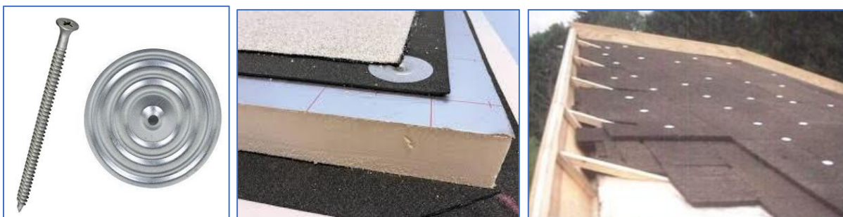
Figuur 24. De metalen schroeven gaan dwars door de isolatieplaat heen en verwarmen de ronde metalen plaat. Dit resulteert in de warmtelekken die op de vorige foto's zijn te zien.
