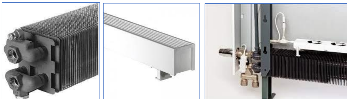
Figuren 5. Convectorradiatoren hebben extra veel dunne lamellen waardoor de warmteafgifte sneller gaat. (Foto Jaga). Meestal zijn deze laag geplaatst en breed. Het technische warmteafgifte oppervlak wordt nog eens 30% groter met ventilatoren op de radiatoren. Bij hoog-rendement convectorradiatoren zijn ze ingebouwd.
