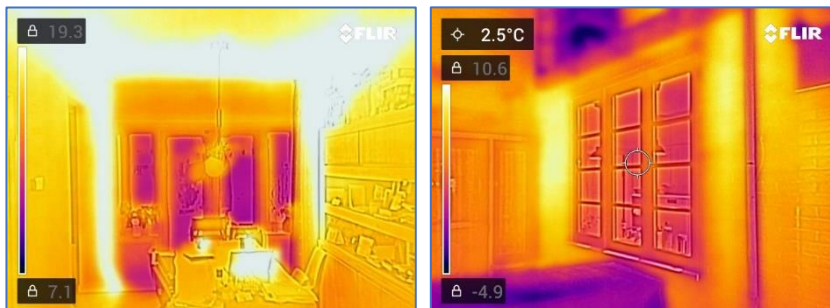
Rechts: Buiten IR-foto van een niet-geïsoleerde spouwmuur, waar binnen aan elke kant naast de ramen een verticale designradiator zit. De warmte concentreert zich aan de bovenzijde.
