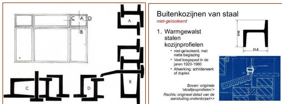
Figuren 4. Voorbeeld van stalen stoeltjesprofielen. De vaste ruiten zijn geplaatst in de profielen A en D zonder het draibare profiel.
