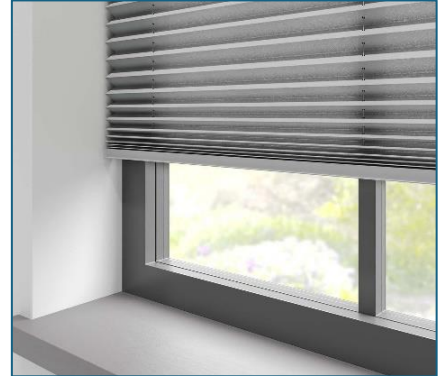
Figuur 17. Plissé binnen heeft alleen isolerende werking in de winter wanneer het goed aansluit tegen het kozijn. Donkerkleurige plissé kan thermische breuk van isolatieglas opleveren. Een plissé of vouwgordijn dat dicht langs het raam loopt, onder en langs de zijkanten goed aansluit tegen het kozijn of vensterbank zal een luchtlaag vormen die iets isoleert 7 .
