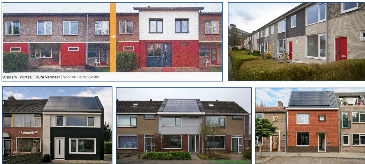
Figuren 24. Het resultaat bij na-isolatie van buitengevels kan per project sterk verschillen. Rechtsboven is door een voorzetgevel en het gebruik van gelijksoortige e-board panelen een eenheid in de architectuur ontstaan.
