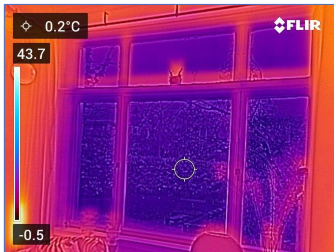
Figuren 8. Monument (pijl) met erg slecht isolerend monumentenglas (Rg 0,2). Rechts . IR foto van binnenuit.
