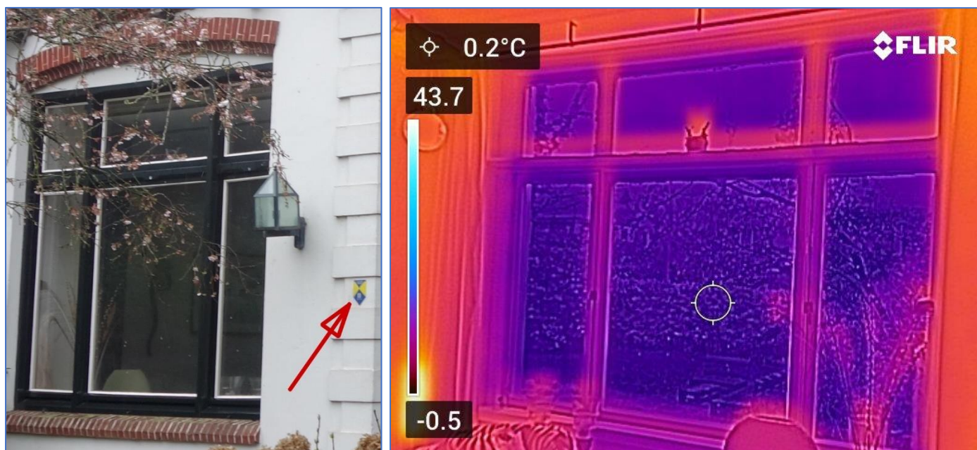
Figuren 8. Monument (pijl) met erg slecht isolerend monumentenglas (Rg 0,2). Rechts . IR foto van binnenuit.
