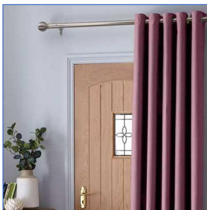
Figuur 10. Links: Voor een isolerend gordijn is dit een verkeerde montage omdat de bovenkant en de zijkanten open zijn. Ook moet het gordijn goed op de grond aansluiten (figuur 1 links).
