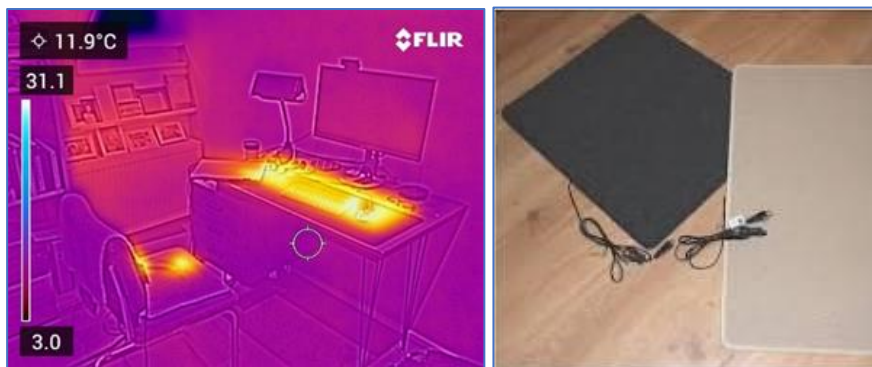
Figuren 29. Links . Een keyboard verwarming of Rechts . een elektrisch verwarmde mat onder een dun vloerkleedje zijn goede methoden voor plaatselijke verwarming.
