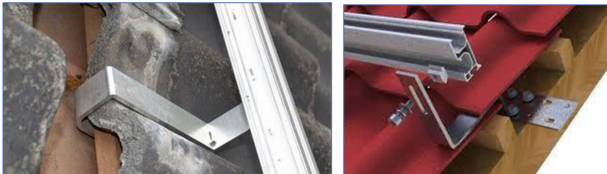
Figuren 34. Bevestiging van PV-panelen gebeurt vaak met aluminium haken die achter de panlatten haken. Hiervoor moeten de panlatten van goede kwaliteit zijn. Rechts . Er bestaan ook bevestigingen die direct op het dakbeschoot geschroefd worden, maar niet elk PV-bedrijf heeft deze.
