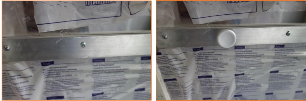
Figuren 7. Voor en na het plaatsen van de knop. Voor het handvat moet het gaatje iets groter geboord en door de midden regel heen.
