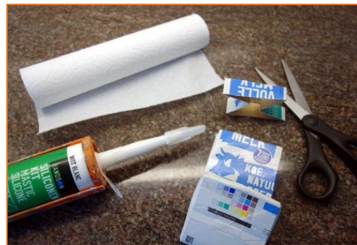
Figuur 8. Als u niet handig bent in kitten, dan eerst de ruit aflakken met glastape. Na een dag de restjes verwijderen met droog keukenpapier. NIET met een keuken nylon (schoor)sponsje, want dat kan de kunststofplaat krassen. Restjes kit kunnen met wasbenzine (sticker-verwijderaar) verwijderd worden.
